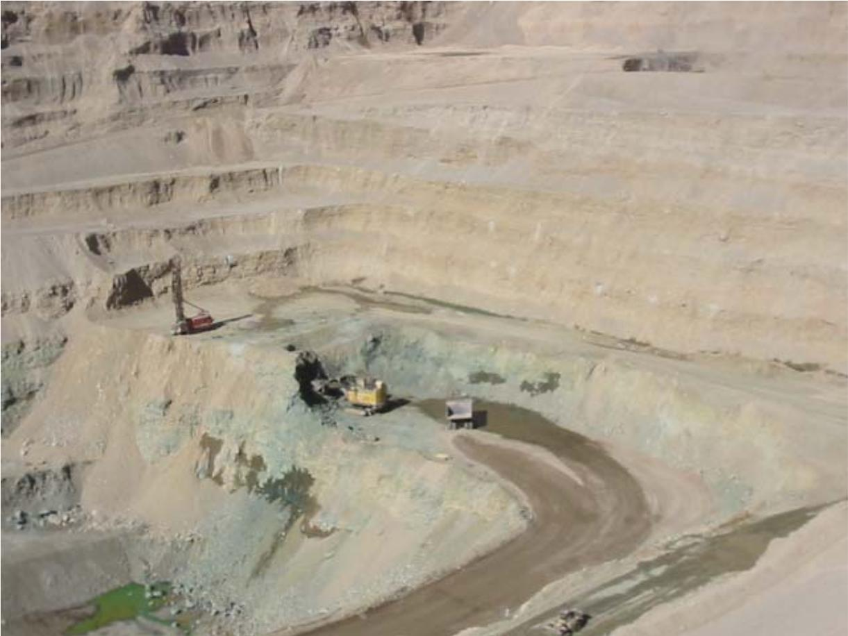
FOTO: Perforadora que emplea sistema de rotación y empuje
